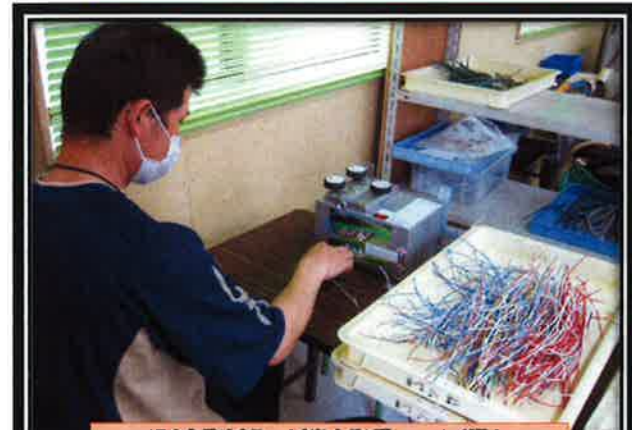
銅線剥離 (機械通し作業)
