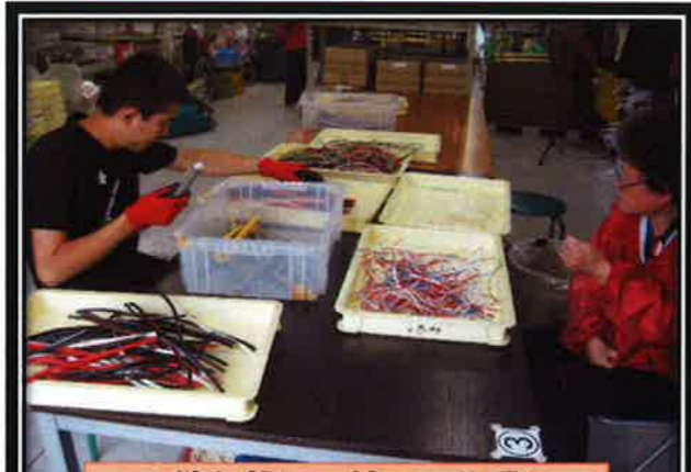
銅線剥離 (銅線取り作業)
